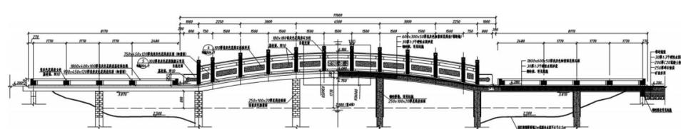
清和公园四号桥：位于湿林栈道与观景平台之间，全长33米，宽4.5米，微拱形桥，采用钢筋砼结构，桥身用浅灰色花岗岩粗凿面贴面，桥面间隔1.5米栏杆为青灰色荔枝面花岗岩凹面石拦板。
