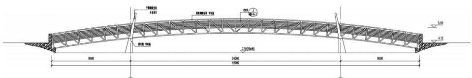
胜利塘河公园4号桥：位于总部经济园东侧，桥长42米，宽4米，单孔洞拱桥，采用钢架结构，桥板用防腐硬木，采用不锈钢磨砂面栏杆扶手。桥名设置于桥头两侧。
