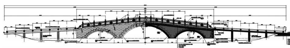
清和公园一号桥：全长59米，宽5.3米，一大两小三孔洞拱形桥，采用钢筋砼结构，桥身用浅灰色花岗岩粗凿面贴面，桥面栏杆为青灰色荔枝面镂空雕花花岗岩石拦板。
