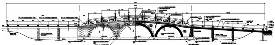
清和公园七号桥：位于滞洪区中心位置，两座连桥，桥长46米，宽4.5米，一大两小三孔洞拱桥，采用钢筋砼结构，桥身用浅灰色花岗岩粗凿面贴面，桥面每隔2.4米为青灰色荔枝面镂空花岗岩石拦板。
