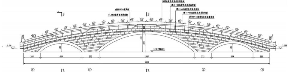
胜利塘河公园1号桥：位于上海花园南侧，胜利塘河西入口临近胜利闸位置，桥长39.2米，宽4米，一大两小三孔洞拱桥，采用钢筋砼结构，桥身用浅黄色花岗岩荔枝面贴面，桥面每隔1.5米木拦板。
