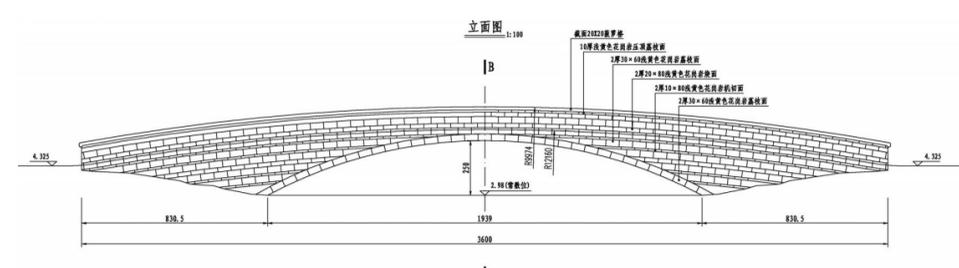
胜利塘河公园5号桥：位于胜利塘河纪念碑西侧，桥长36米，宽4米，单孔洞拱桥，采用钢筋砼结构，桥身用浅黄色花岗岩荔枝面贴面，桥面花岗岩贴面拦板。
