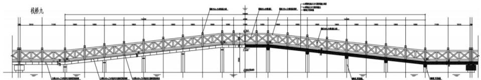
清和公园绿道栈道九号桥：全长33米，宽3.5米，为跨式拱桥，采用钢筋砼结构，桥身用浅灰色花岗岩贴面，桥面为绿道彩色沥青混凝土面层，每隔1.8米为木立柱栏杆。木桥名设置于桥头两侧。
