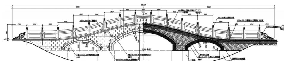
清和公园三号桥：连接观景平台与芦滩栈道两岛，全长30米，宽4.5米，一大两小三孔洞拱形桥，采用钢筋砼结构，桥身用浅灰色花岗岩粗凿面贴面，桥面每隔1.8米栏杆为青灰色荔枝面镂空雕花花岗岩石拦板。
