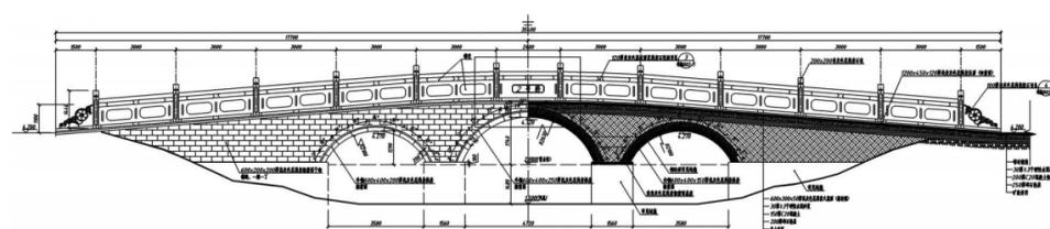
清和公园二号桥：全长35米，宽4.5米，一大两小三孔洞拱形桥，采用钢筋砼结构，桥身用浅灰色花岗岩粗凿面干砌，桥面每隔3米栏杆为青灰色荔枝面镂空雕花花岗岩石拦板。
