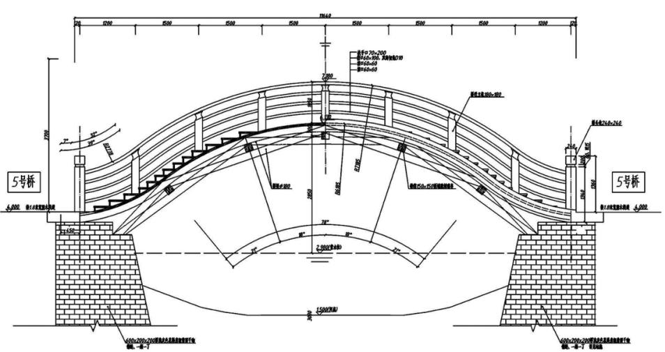
清和公园五号桥：位于湿林栈道岛屿之间，连接两头小岛木铺地，全长11.6米，宽3.1米，为木头结构拱形桥，桥侧木栏杆。桥名设置于桥头两侧。
